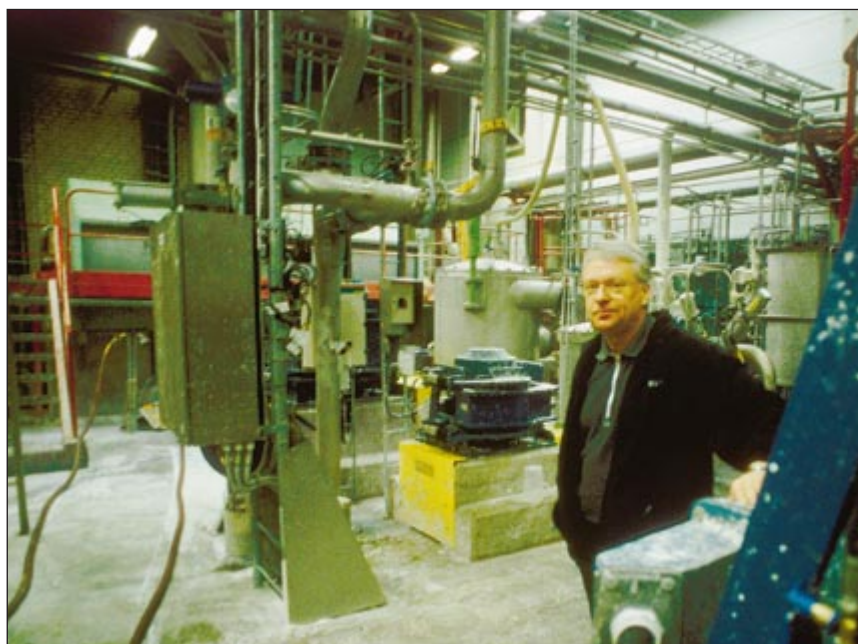
Enligt Kurt Forsman har tidsåtgången för ett rembyte sjunkit drastiskt. Förr kunde det ta upp till en halv dag. Nu handlar det om tio till tjugo minuter även på en sådan här drift, som driver en tjockmassasil.
